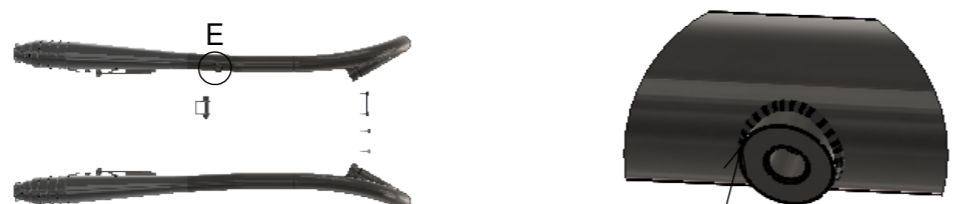
014701 12mm O2センサーバング ステンレス 12in 詳細図 E スケール 1 : 2
